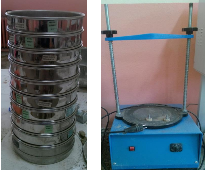
Şekil 1. Elek takımı ve Elek Sarsma tablası
