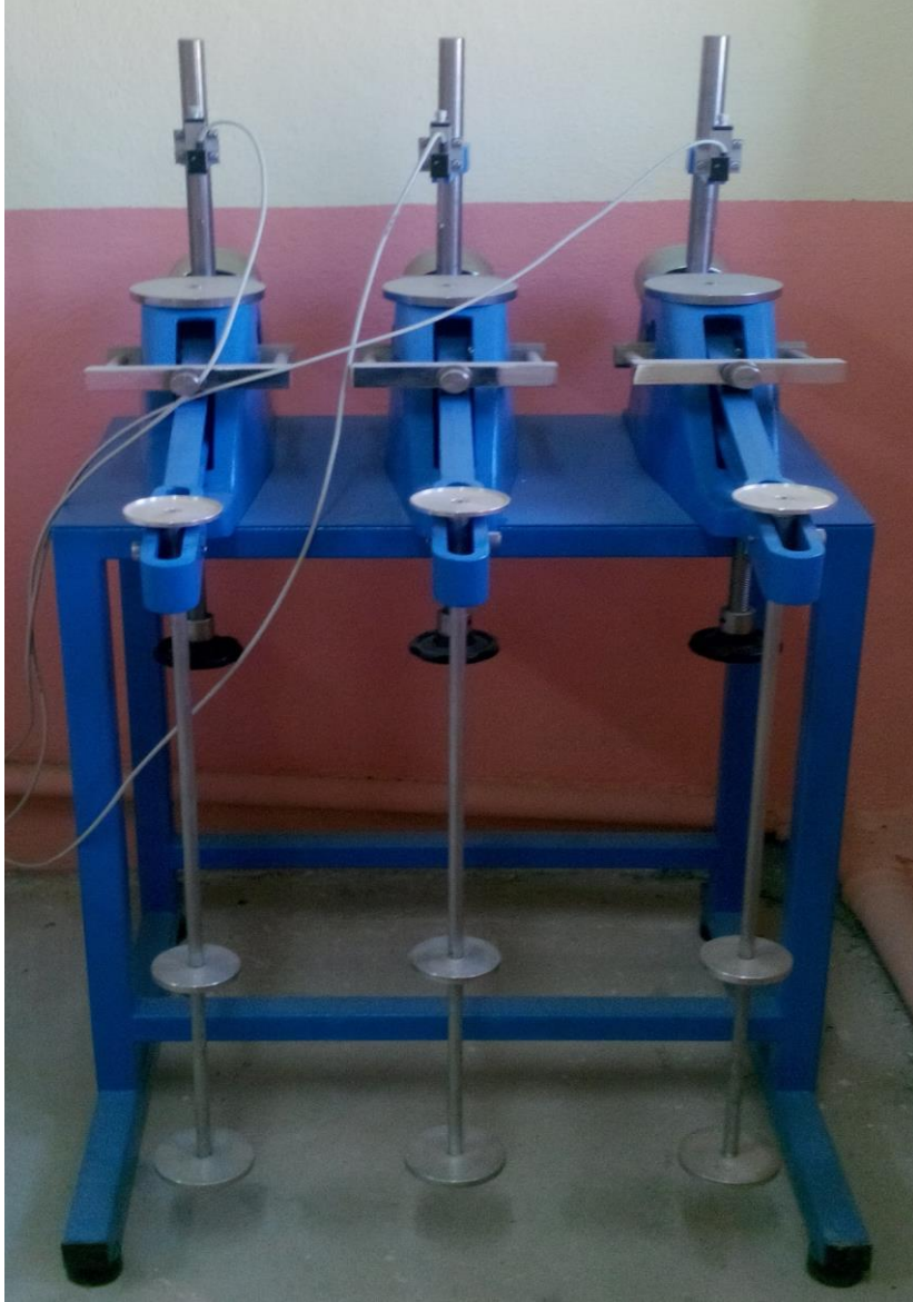
Şekil 8. Konsolidasyon (Ödometre) deney aleti
