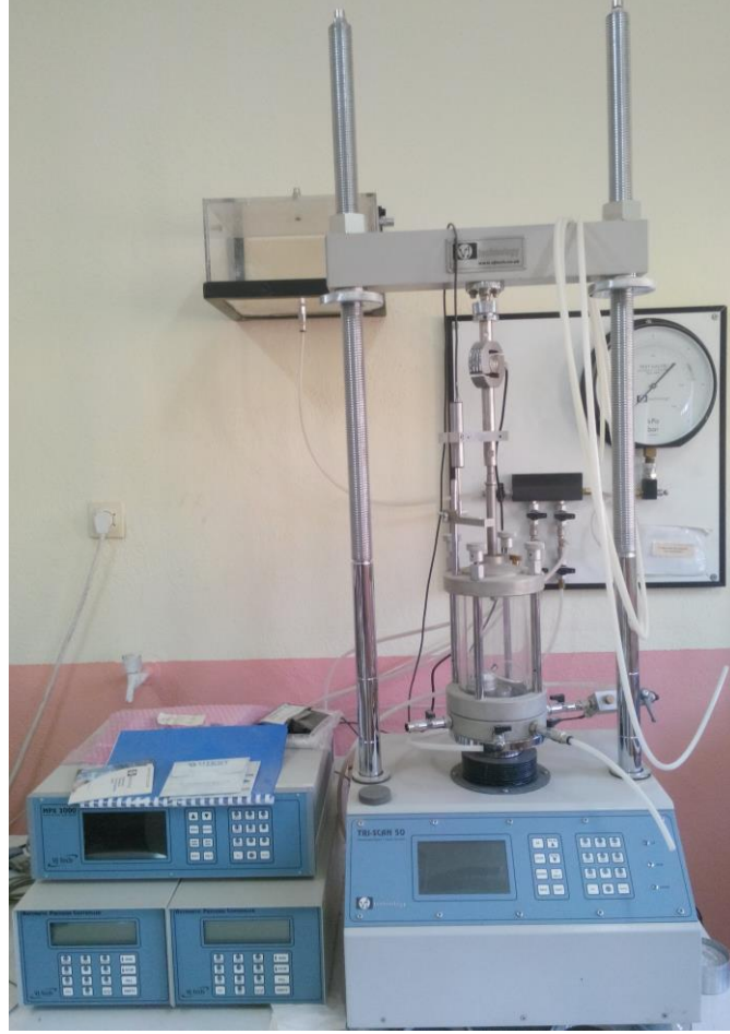
Şekil 6. Üç eksenli deney aleti
