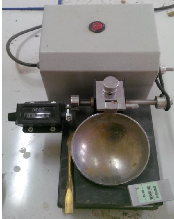
Şekil 4. Likit Limit (Otomatik Casagrande) deney aleti
