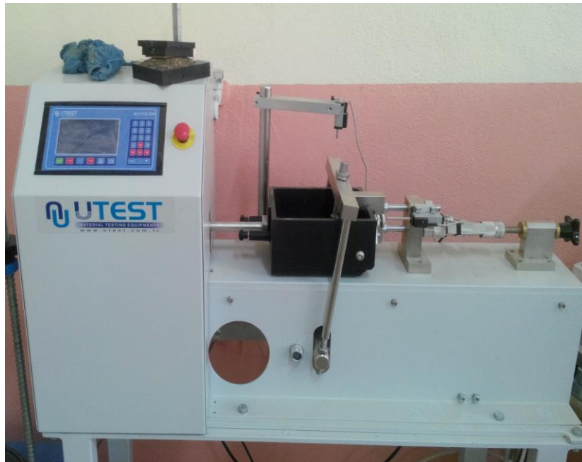
Şekil 7. Kesme kutusu deney aleti
