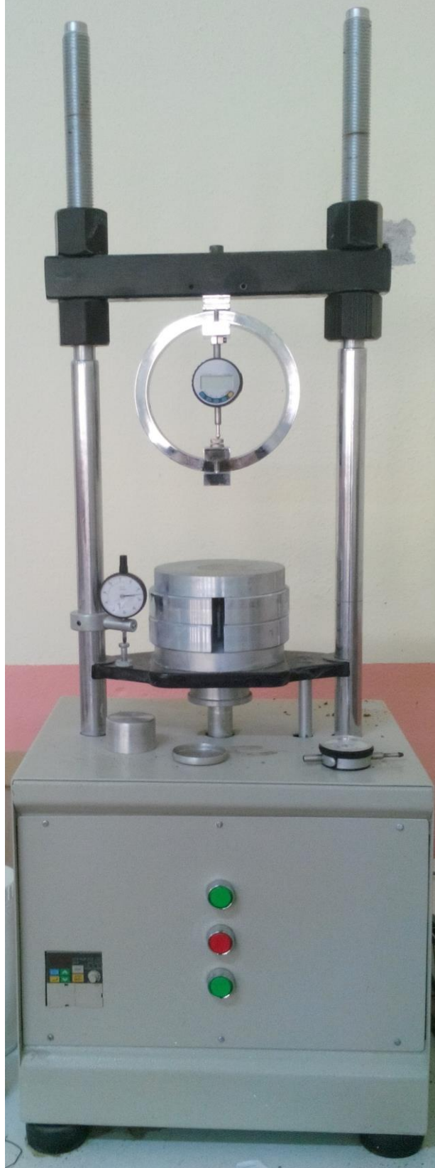
Şekil 5. Tek eksenli deney aleti
